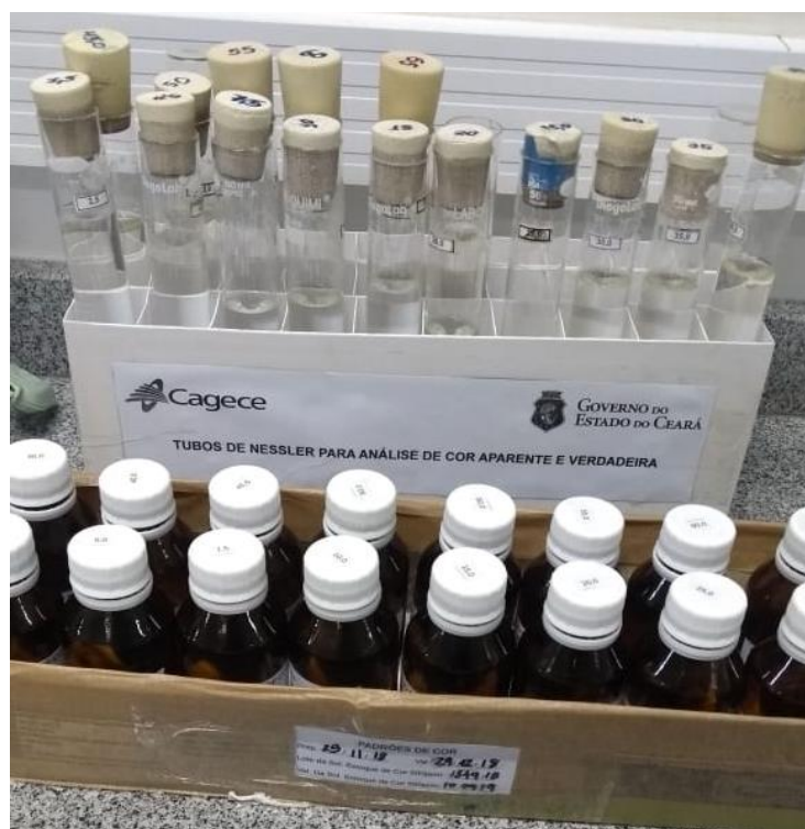
Figura 2- Tubos de Nessler para análise de cor
