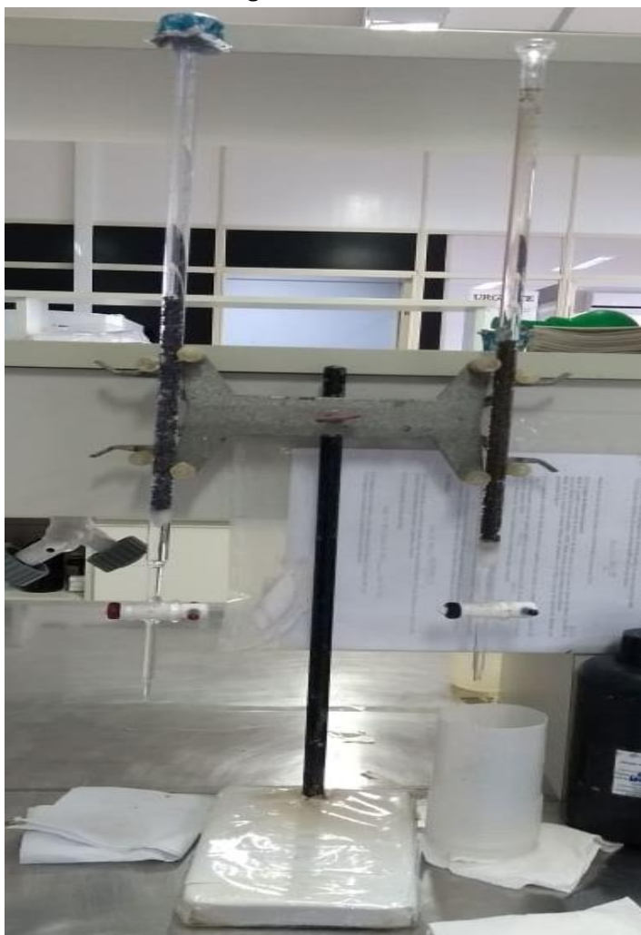
Figura 5- Colunas redutoras de cádmio para análise de nitrogênio total e nitrato
