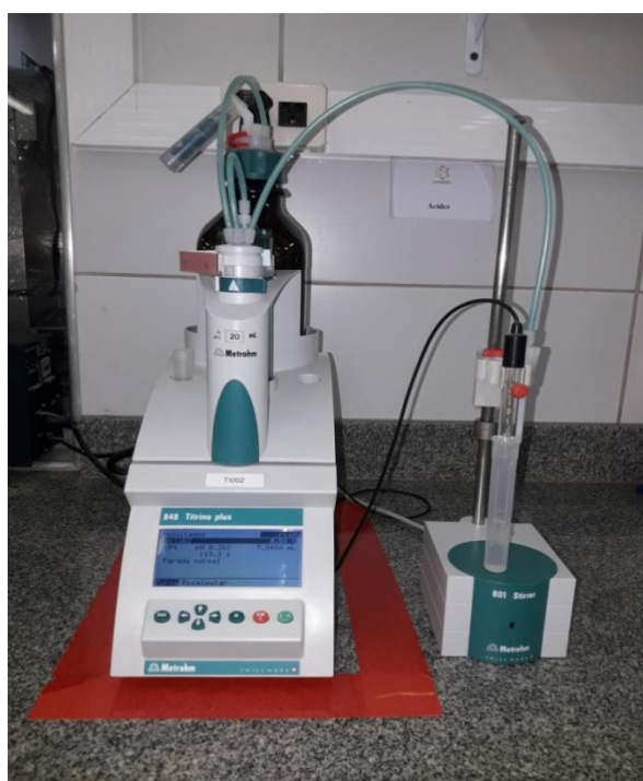
Figura 4: Titulador automático Metrohm - Modelo 848 Titrino Plus para análise de acidez
