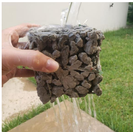
Figura 9. Concreto permeável com 5% de fibra PET durante teste de permeabilidade. Fonte: Autoria própria.
