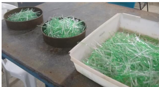
Figura 2. Fibras PET depois de cortadas, lavadas, pesadas e separadas. Fonte: Autoria própria.
