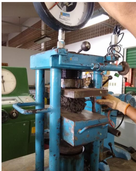
Figura 5. Ensaio de resistência à tração por compressão diametral. Fonte: Autoria própria
