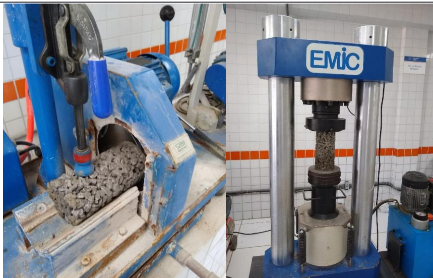
Figura 4. Corpo de prova na retificadora, seguido para a máquina de ensaio. Fonte: Autoria própria
