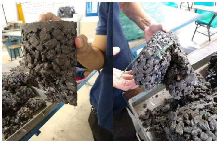
Figura 8. Corpos de prova com 0% e 2,5% de fibra PET, respectivamente. Fonte: Autoria própria.
