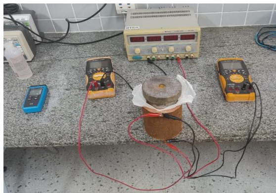
(b) Esquema real do método de quatro pontas
