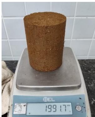
Figura 4 – Corpo de prova após moldagem
