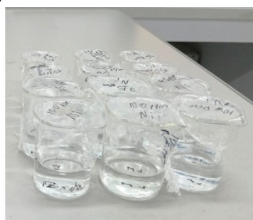
Figura 9. (a) Medição das propriedades dielétricas das soluções de metais com kit DAK e VNA; (b) amostras preparadas.
