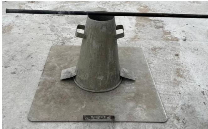
Figura 8: Molde de tronco de cone utilizado para verificar o slump test
