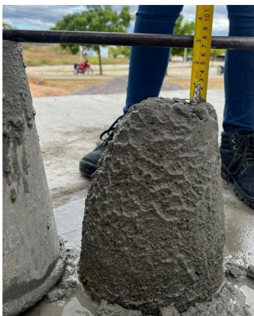
Figura 17: Resultado Slump Test
