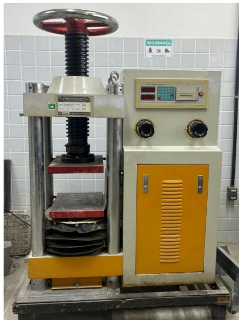
Figura 16: Ensaio de compressão axial
