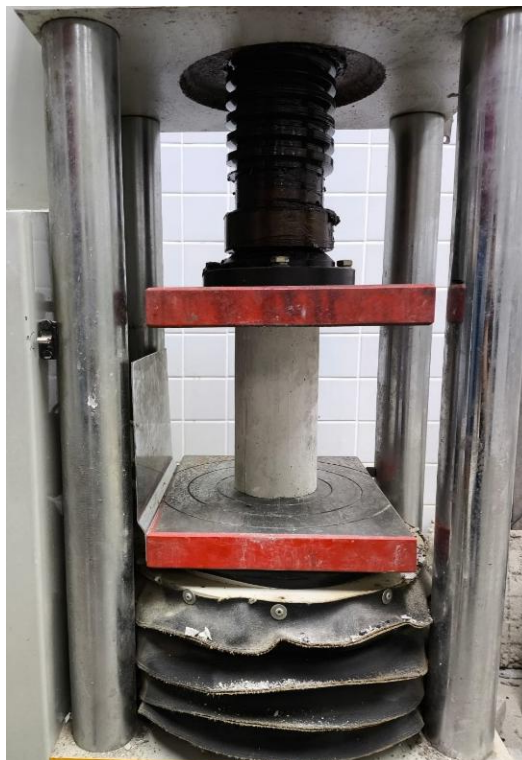
Figura 18: Ensaio de compressão axial
