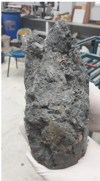
Figura 1 – Corpo de prova de Concreto seccionado
