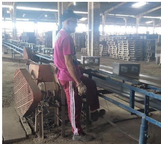
Figura 7 – Funcionário fazendo a retirada do excesso do tijolo
