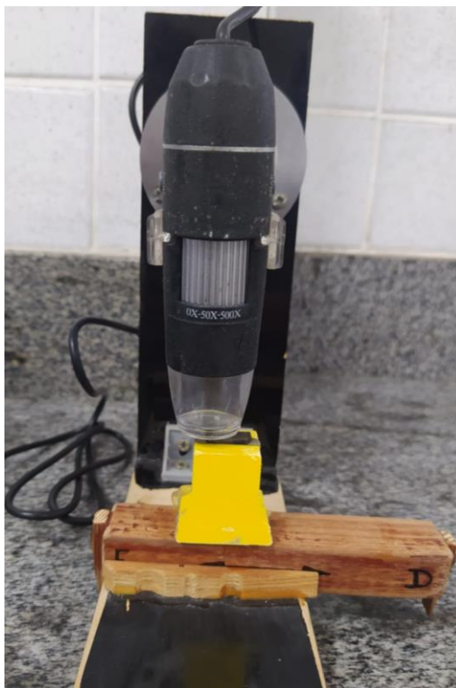
Figura 16 - Medição do desgaste da Ferramenta de Corte
