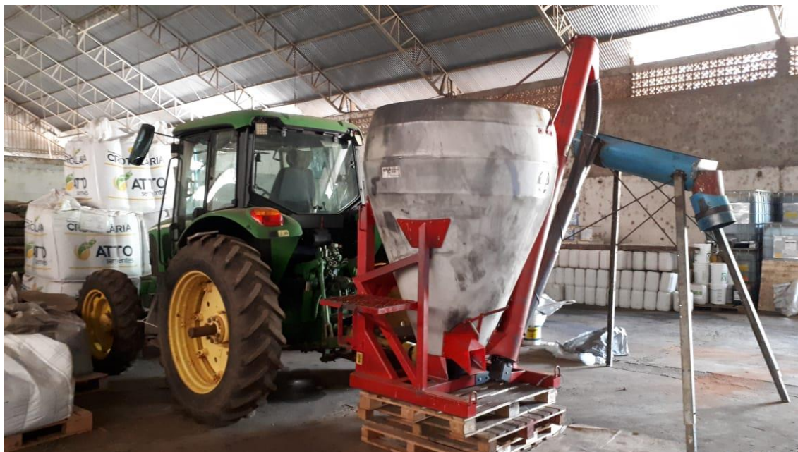
FIGURA 2: TRATADOR MISTURADOR DE SEMENTES ACOPLADO A UM TRATOR JOHN DEERE.
