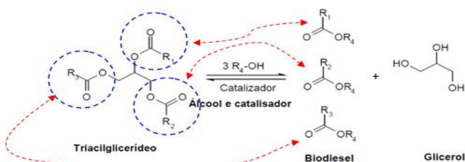
Figura 2: Reação de produção do Biodiesel.
