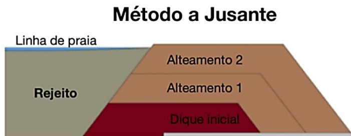
Figura 1 - Método a jusante [3].
