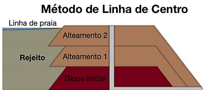
Figura 2 - Método de linha de centro [3].
