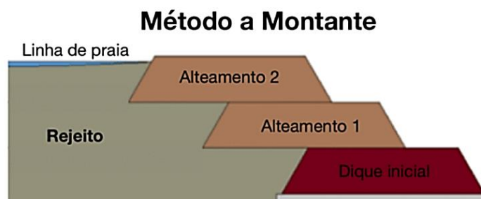
Figura 3 - Método a montante [3].
