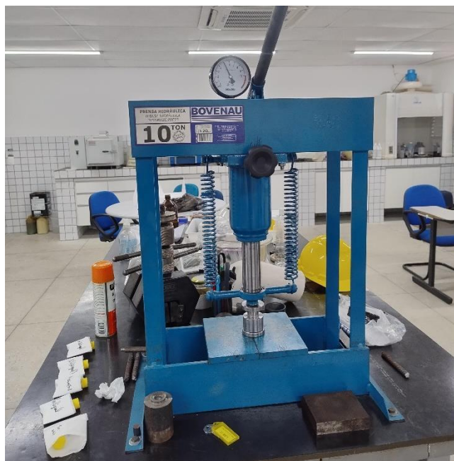
Figura 4. Prensa hidráulica - Hydraulic Press. (Autoria própria)
