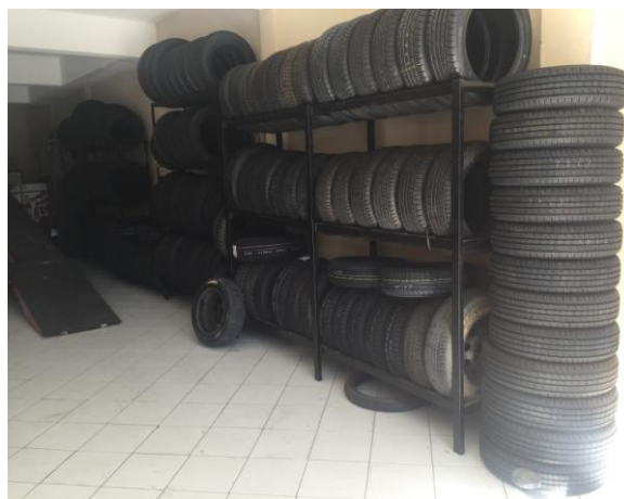
Figura 16 – Forma adequada de armazenamento de pneus nas borracharias de Pau dos Ferros, 2016.
