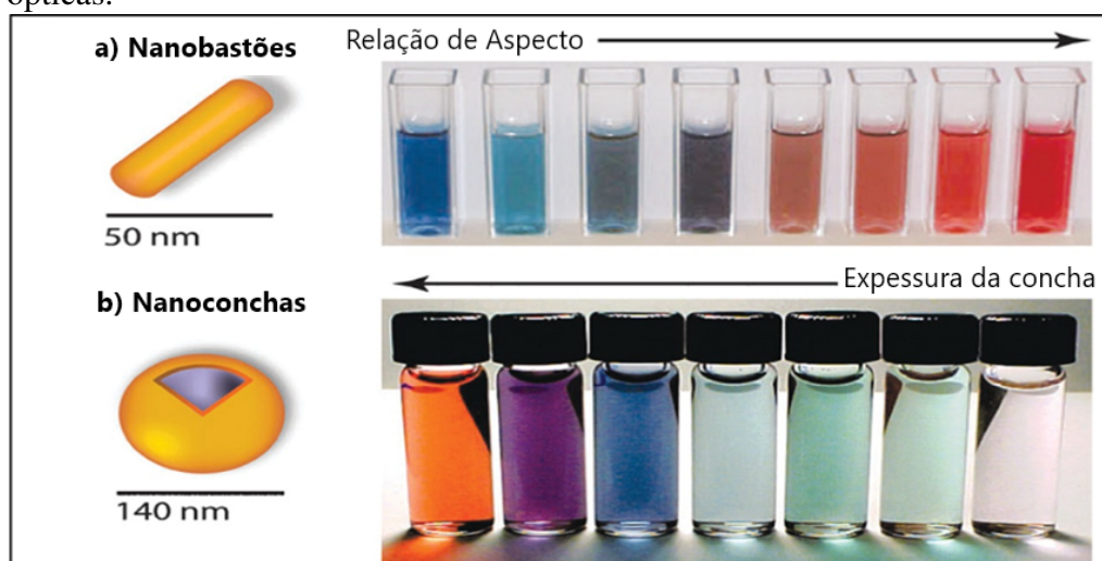
Figura 2.14: Associação de diferentes morfologias e tamanhos de AuNPs com propriedades ópticas.
