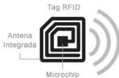
Figura 3: Componentes da Tag Fonte: AFIXGRAF(2015)
