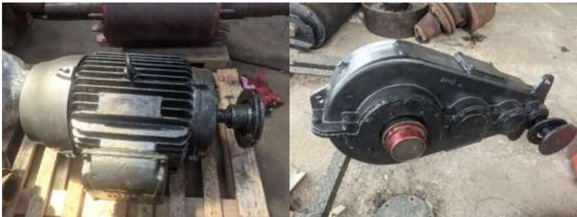
Figura 9 - Motor e redutor utilizados no acionamento do truck
