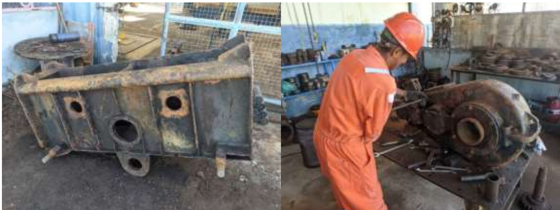
Figura 11 - Desmontagem do truck motriz e redutor
