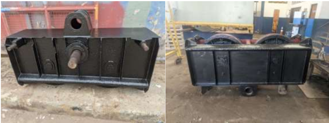
Figura 10 - Truck motriz e truck livre
