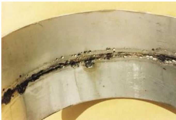
Figura 16: Corrosão em torno de cordão de solda em aço inoxidável.
