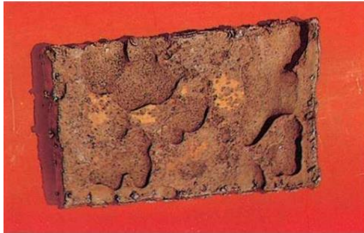
Figura 6: Corrosão por placas
