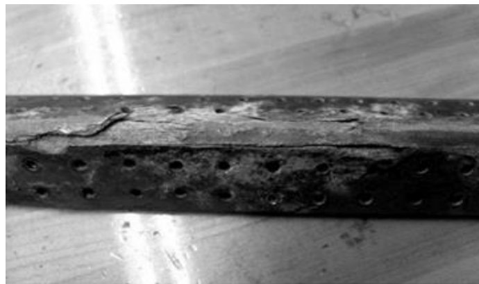
Figura 12: Corrosão por esfoliação
