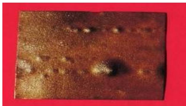
Figura 15: Chapa de aço carbono com empolamento por hidrogênio
