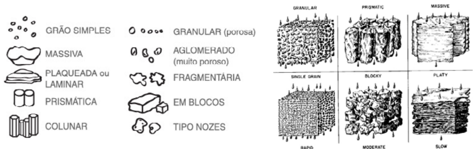
Figura 4. Tipo de estrutura e sua relação com a passagem de água. Fonte: Salemi (2009).
