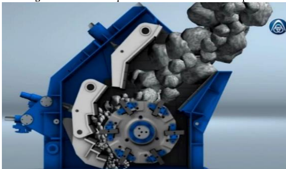
Figura 9: Desenho esquemático de um britador de impacto
