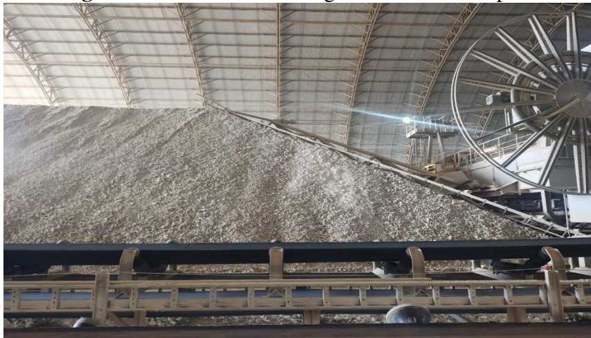
Figura 13: Retomadora de argical na Cimento Apodi
