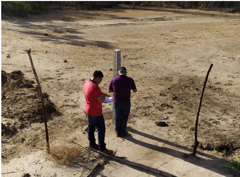
Figura 7: Medição de um terreno rural e coleta das suas coordenadas geográficas para a confecção de um memorial descritivo realizada na cidade de Russas-CE. Fonte: Genilson Araújo, 2021.
