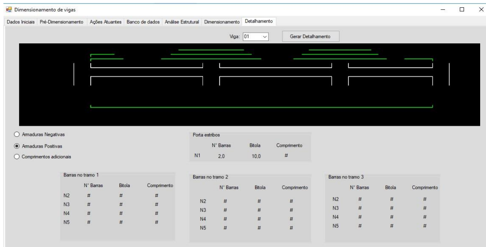
Figura 29 - Detalhamento e descrição de armaduras positivas
