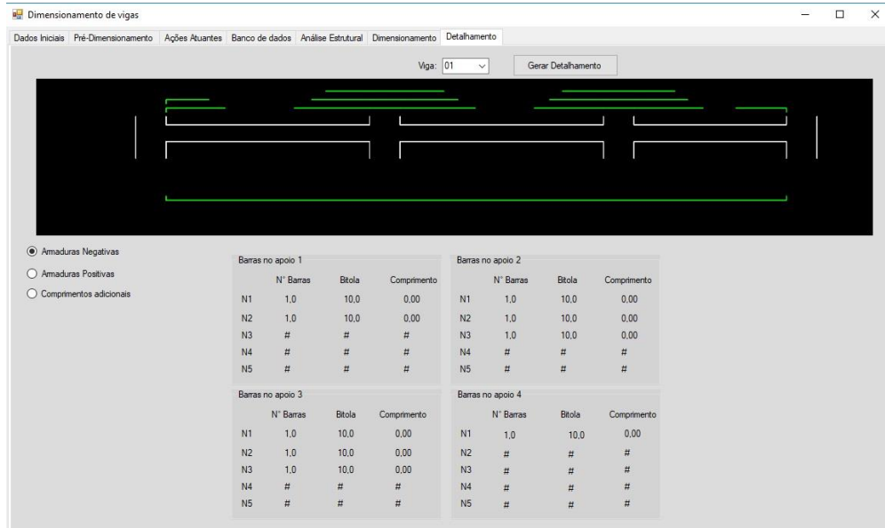
Figura 28 - Detalhamento e descrição de armaduras negativas
