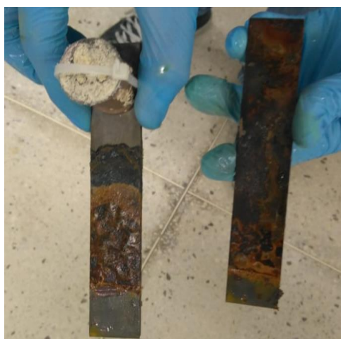
Figura 9. Aspectos corrosivos dos Eletrodos na última análise. (Autoria própria)
