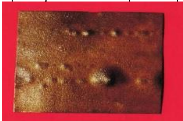
Figura 14: Chapa de aço-carbono com empolamento por hidrogênio.
