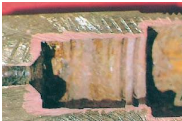
Figura 13: Dezincificação em parte interna do componente de latão.
