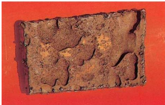
Figura 5: Corrosão por placas em chapa de aço-carbono.
