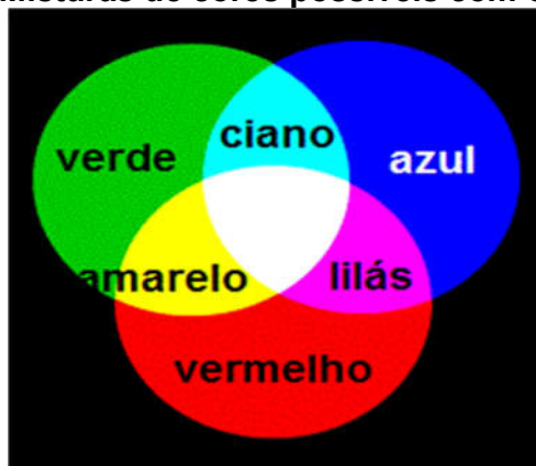
Figura 7: Misturas de cores possíveis com o LED RGB
