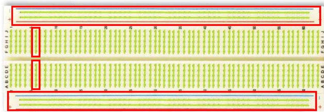
Figura 11: esquema interno de ligação do protoboard
