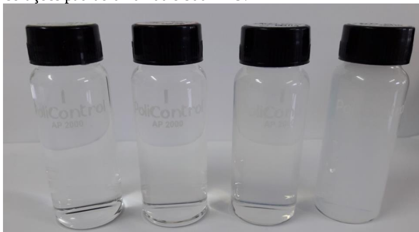
Figura 20 - soluções padrão 0 20 100 e 800 NTU.
