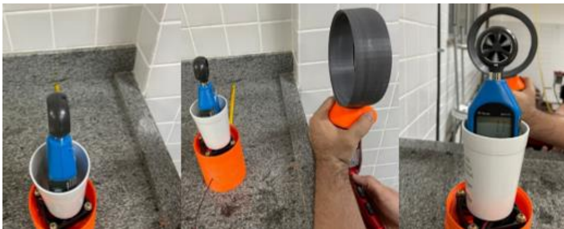
Figura 28 – Coleta de dados no ponto L2 utilizando o soprador acoplado ao ventilador
