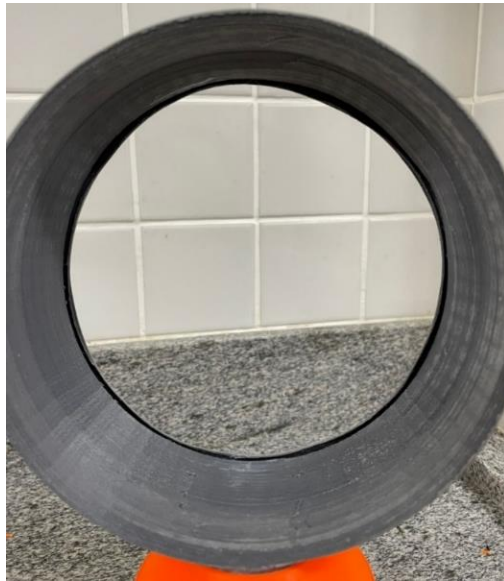
Figura 14 – Perfil após ajuste do ângulo de saída
