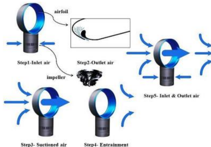
Figura 7 - Mecanismo de entrada e saída de fluxo de ar em um ventilador sem pás
