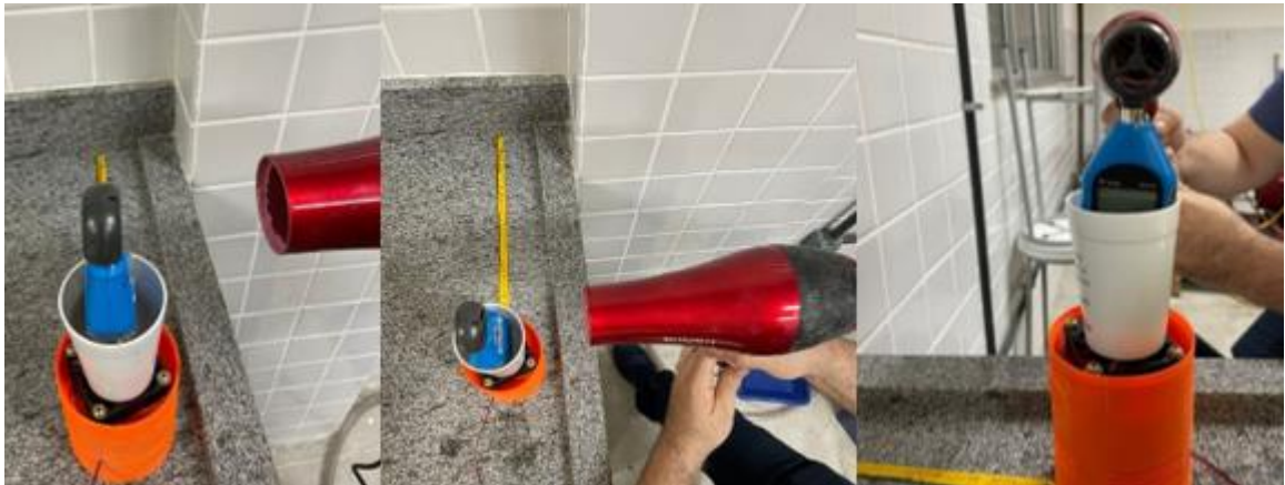
Figura 29 – Coleta de dados do soprador apontado diretamente na 1ª distância
