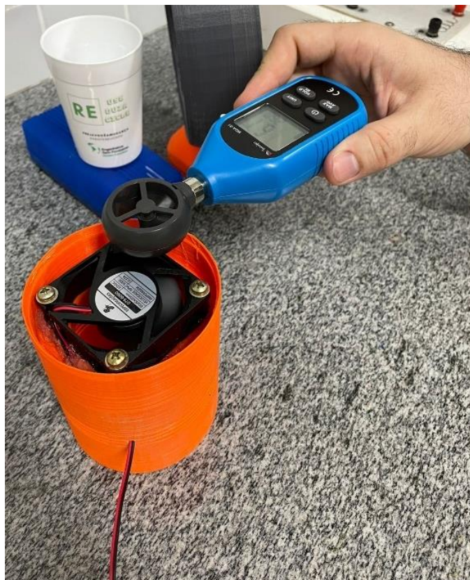
Figura 32 – Leitura com o cooler fixado à base
