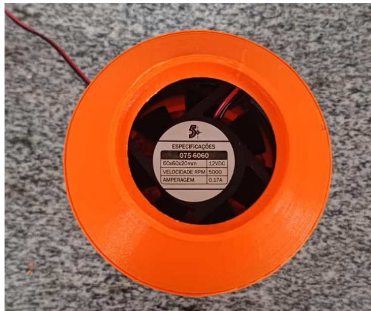
Figura 20 – Vista superior com base e conector encaixados
