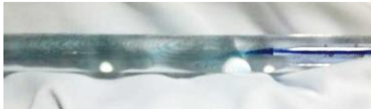
Figura 5 - Comportamento experimental do regime turbulento
