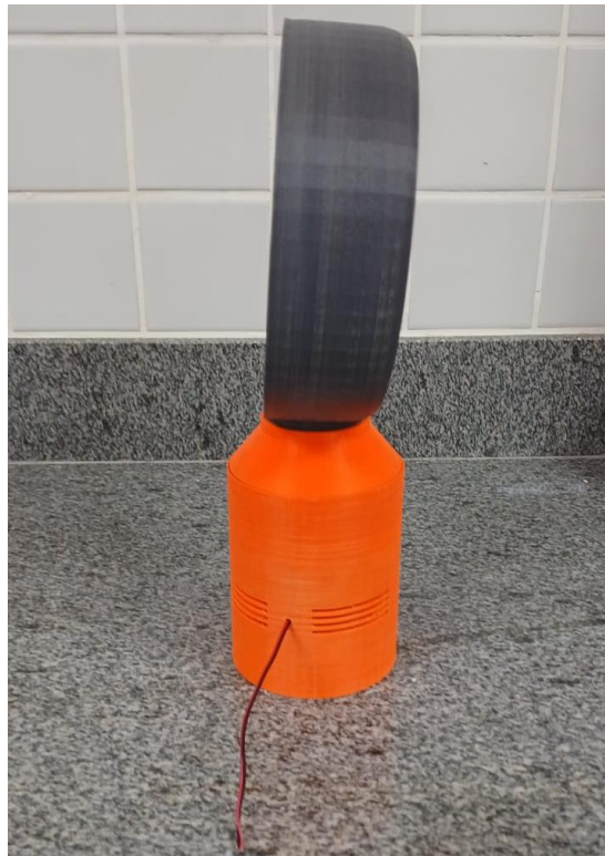
Figura 21 – Vista lateral com abertura realizada para passagem dos fios
