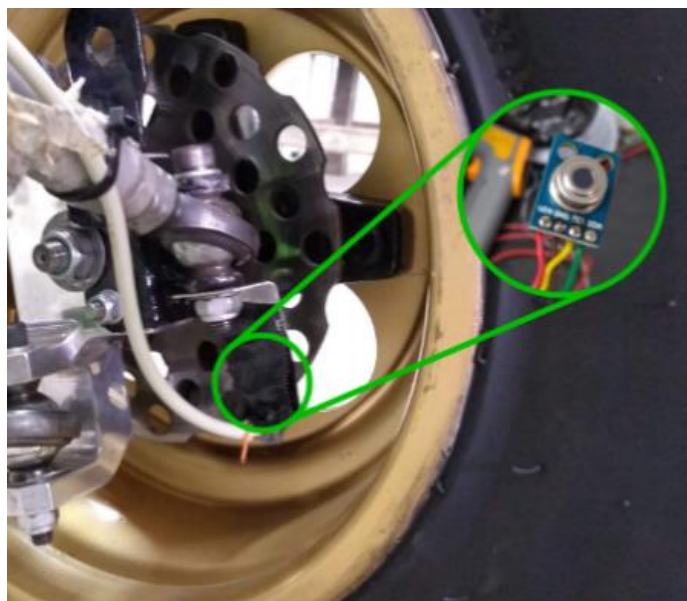
Figura 1 - Localização do sensor de temperatura e sua fixação (autoria própria).
