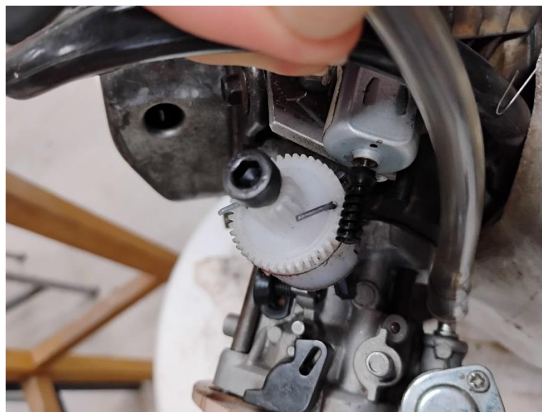
Figura 9 - Adaptação de rosca sem fim na borboleta de aceleração.
