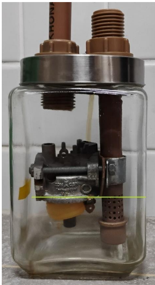
Figura 14 - Altura adequada da coluna de combustível e adaptação de boia.
