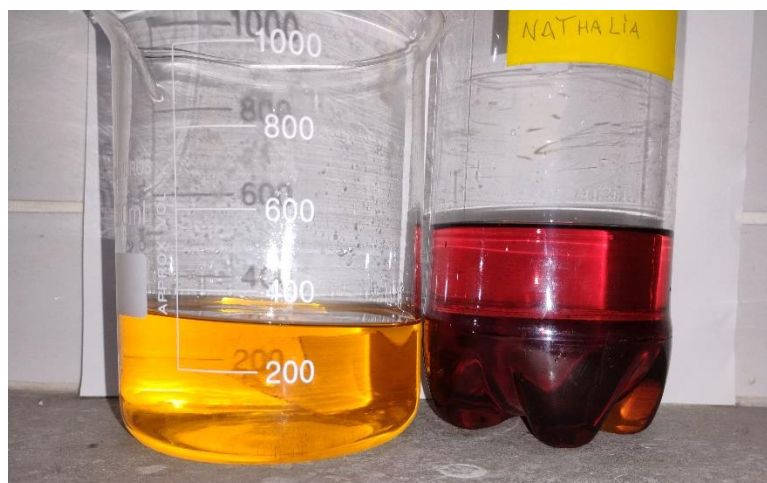
Figura 15 - Combustível não utilizado (esquerda) e combustível após o borbulhamento (direita).
