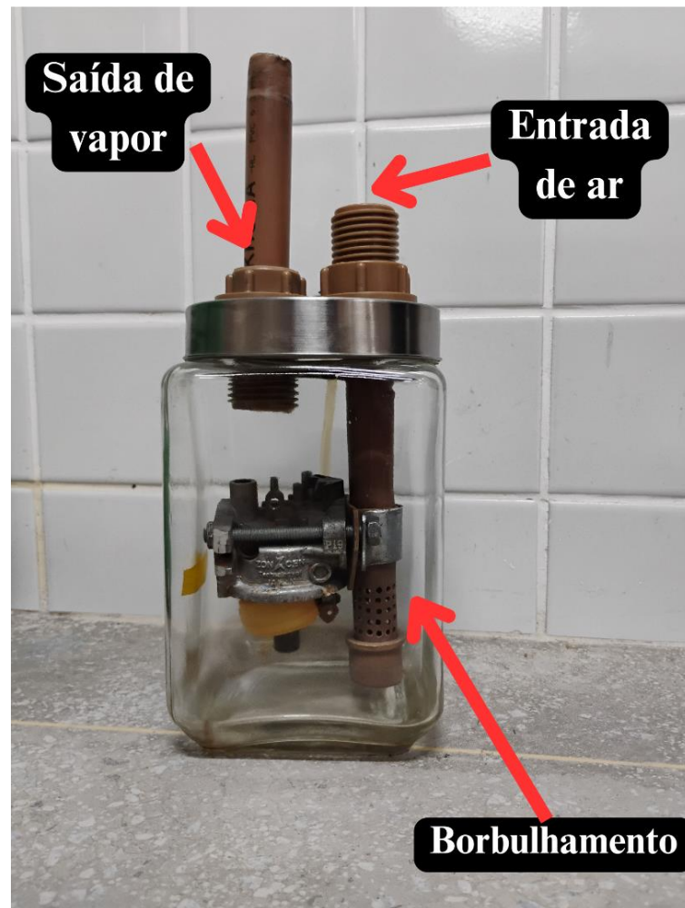
Figura 12 - Carburador secundário de vapor modificado.
