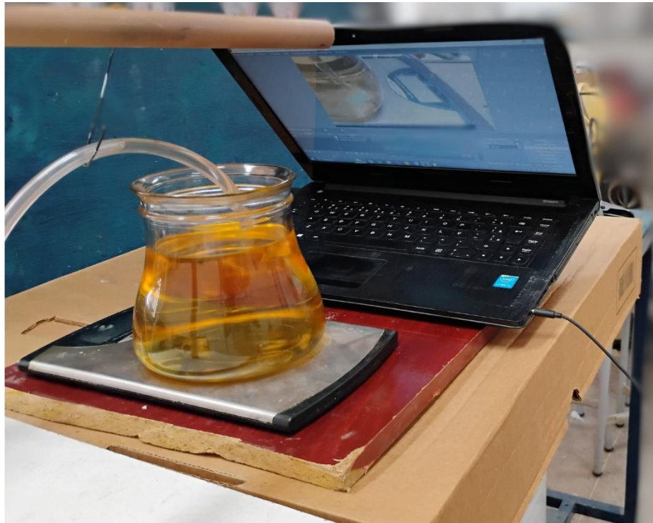
Figura 6 - Bancada de combustível e captação de vídeo.
