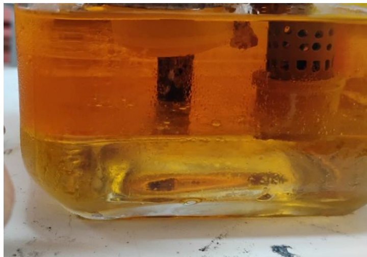
Figura 26 - Evolução da divisão de fases após o quarto ensaio.
