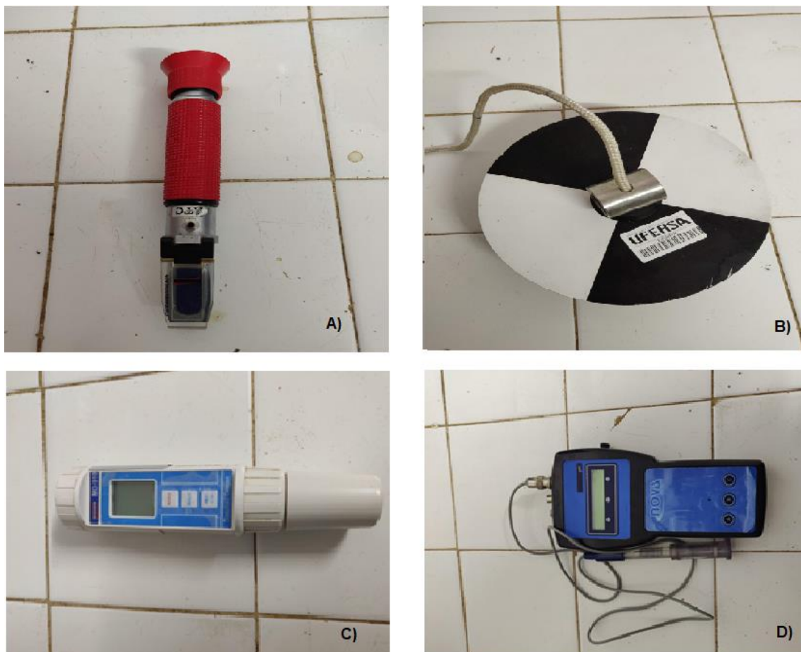
Figura 2: A) salinômetro para verificar a salidade da água; B) disco de Secchi. Usado para medir a transparência da água; C) oxímetro portátil modelo MO-910, Phmetro da marca nova modelo NI PHp
