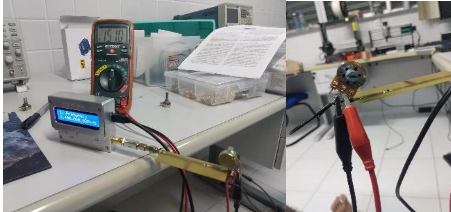
Figura 4.9: Configuração usada na medição das rectennas com carga.
