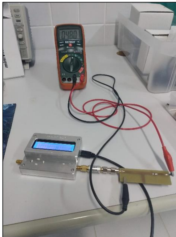
Figura 4.7: Segundo setup usado para medição das rectennas .
