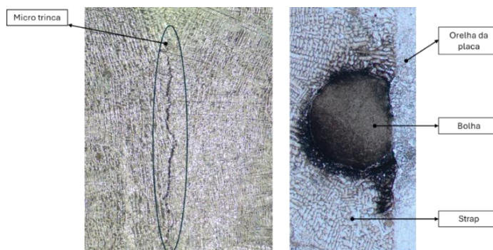
Figura 11. Defeitos solda COS. Autoria própria.
