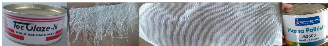
Figura 4. a) resina poliéster; b) fibra de vidro sem direcionamento nas fibras; c) fibra de vidro com direcionamento nas fibras; d) massa de poliéster
