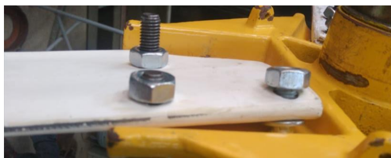
Figura 21. Pá fabricada utilizando uma angulação maior do que a disponibilizada no equipamento
