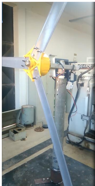
Figura 16. Turbina eólica acoplada a base amortecedora
