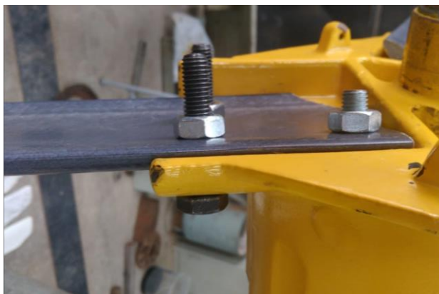
Figura 17. Pá acoplada à turbina sem nenhuma angulação
