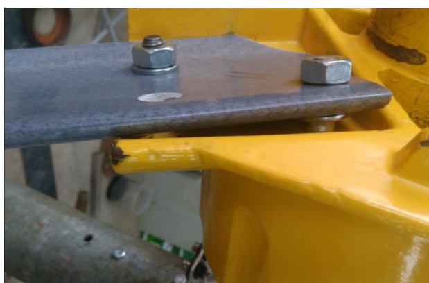
Figura 18. Pá acoplada à turbina com modificação na angulação
