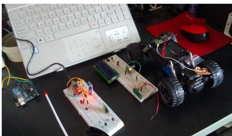
Figura 2 - Carros robôs programados por arduino
