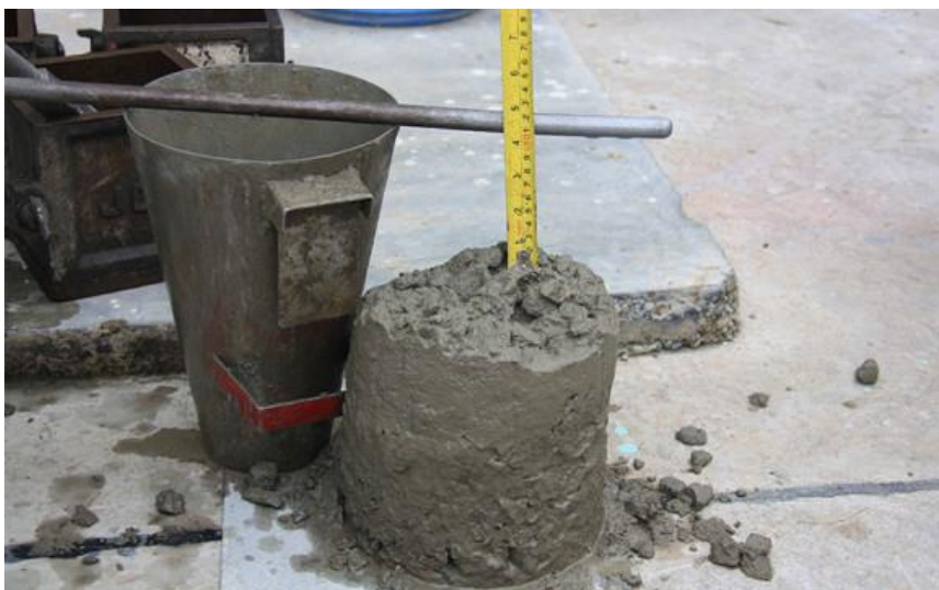
Figura 11: Teste de abatimento com tronco de cone (Slump test)
