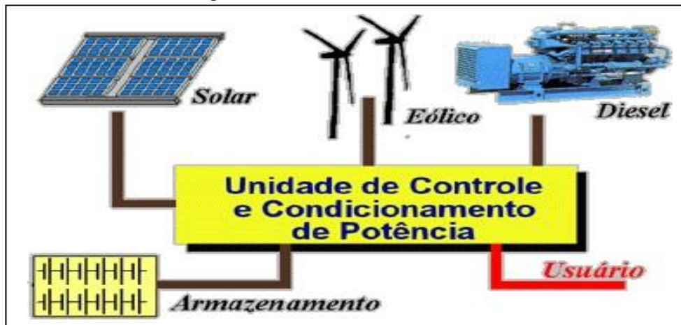
Figura 10 – Sistema fotovoltaico híbrido.
