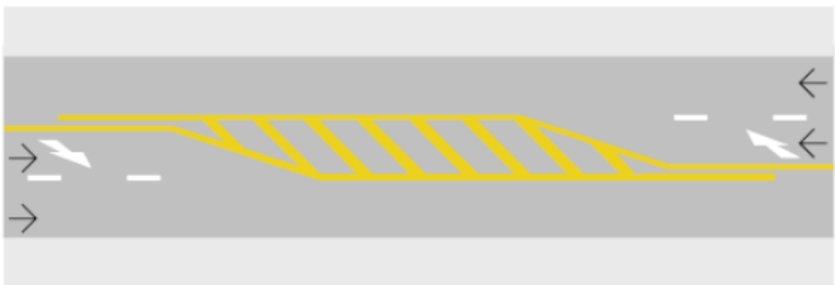
Figura 34: Marcas de canalização
