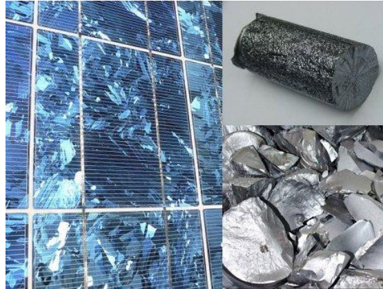
Figura 3: Célula Fotovoltaica a Silício Policristalino
