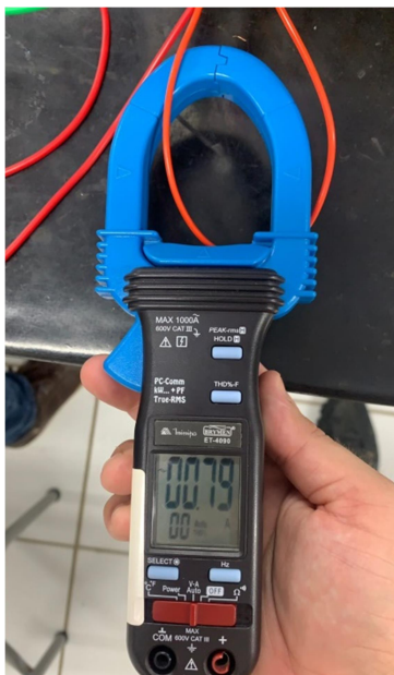
Figura 15 – Amperímetro Minipa ET-4030
