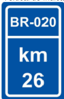
Figura 16 Sinalização Vertical de Indicação de quilometragem
