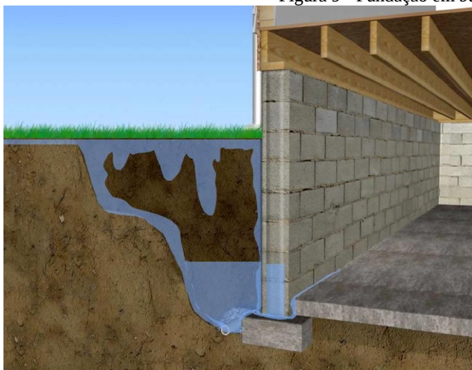
Figura 9 - Fundação em basement wall
