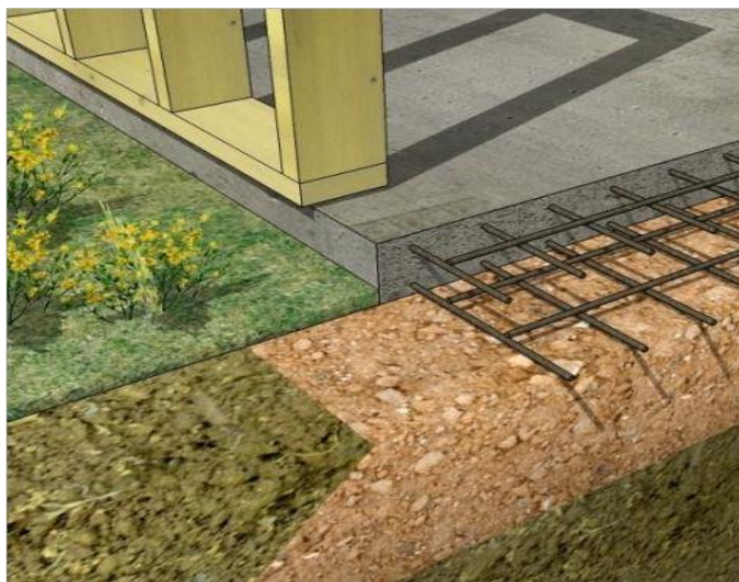
Figura 10 - Fundação do tipo radier
