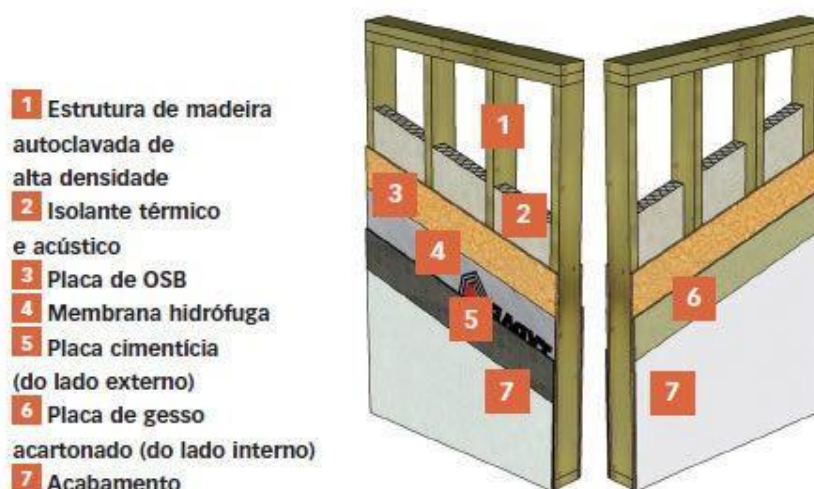
Figura 12 – Esquema da estrutura dos painéis da parede
