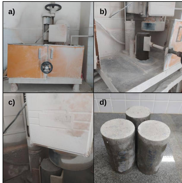
Figura 11 - Retificação dos CPs, sendo: a) equipamento; b) CP posicionado; c) procedimento, e d) CPs retificados
