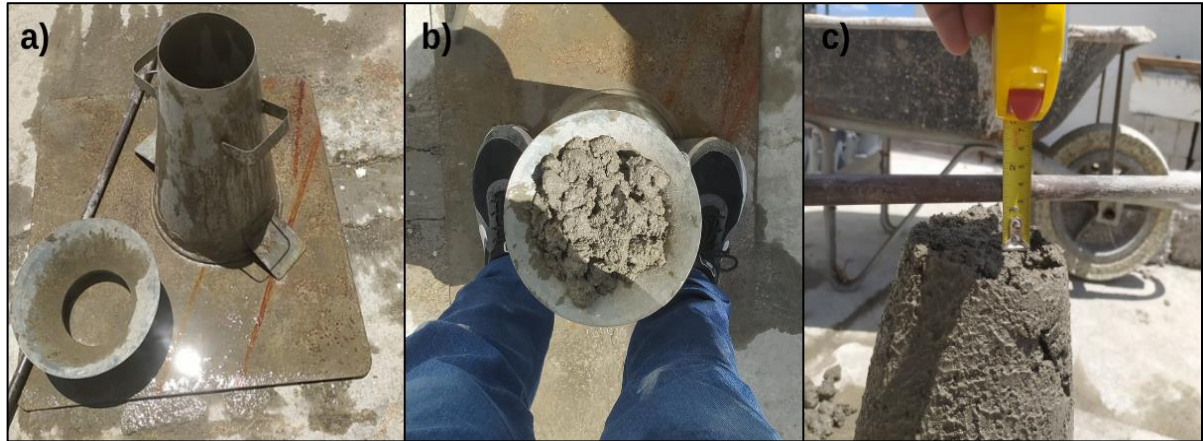
Figura 8 - Determinação da consistência, sendo: a) aparelhagem; b) molde ocupado pelo concreto e c) verificação da consistência
