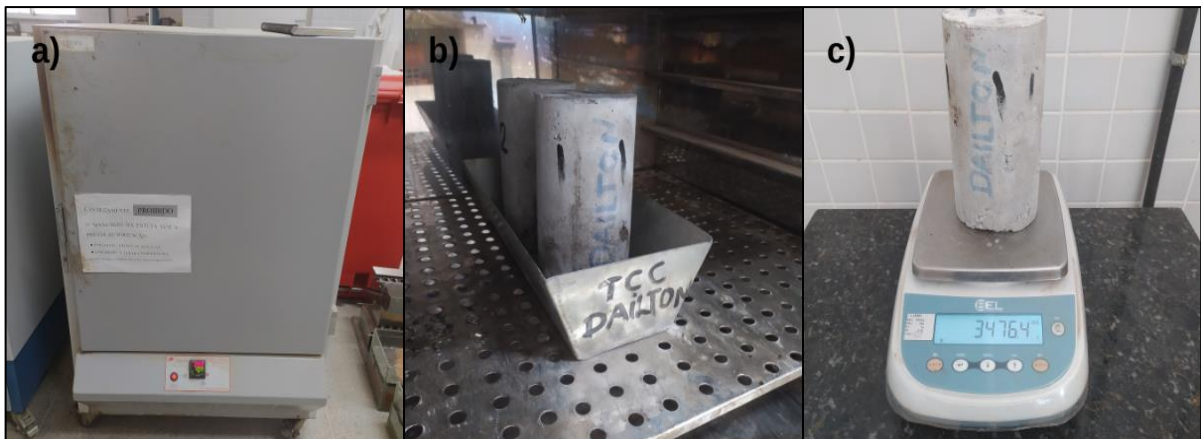
Figura 13 - Obtenção da massa seca da amostra, sendo: a) estufa utilizada; b) CPs em estufa, e c) pesagem dos CPs
