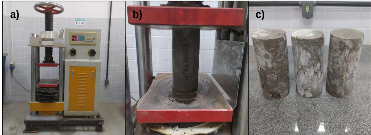
Figura 12 – Determinação da resistência à compressão, sendo: a) máquina utilizada; b) CP posicionado, e c) CPs após rompimento
