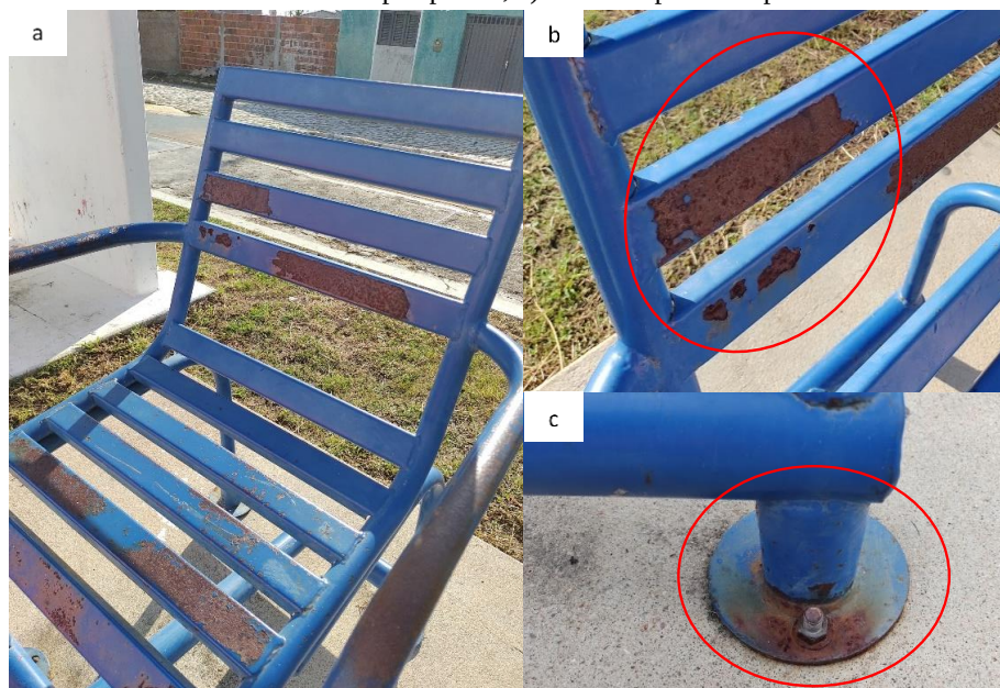
Figura 35: Aparelho bicicleta de cadeira individual, a) região de assento do aparelho com corrosão uniforme, b) região frontal de encostamento com corrosão por placas, c) base de apoio do aparelho com corrosão galvanizada.
