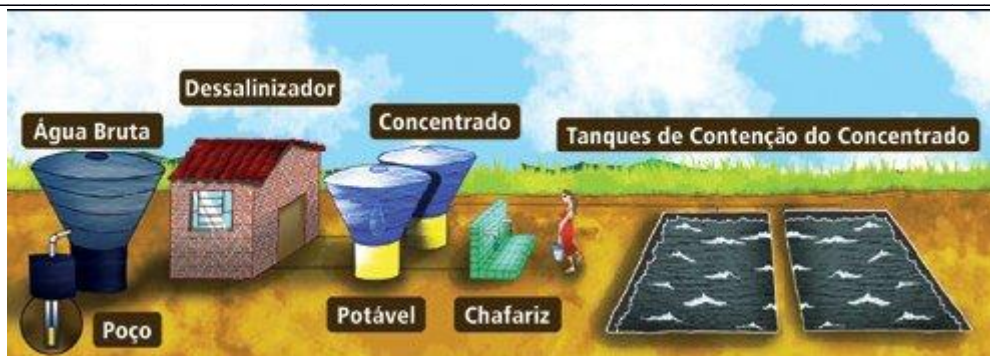
Figura 1: Sistema de dessalinização. Fonte: http://www.mma.gov.br/agua/agua-doce/sistema-de-dessanilizacao.html
