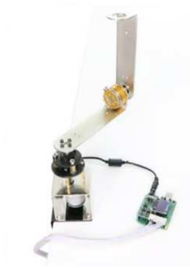
Figura 4 – Modelo físico do pêndulo de Furuta da Wheeltec Technologies .
