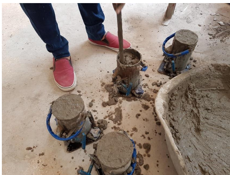
Figura 2: Corpo de prova sendo adensado com haste metálica.
