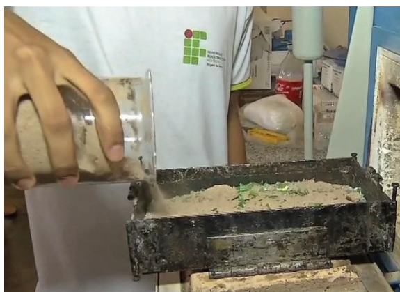
Figura 1. Tijolo produzido com garrafa PET. Fonte: http://g1.globo.com/mato-grosso/noticia/2015/12/estudantes-criam-tijolo-sustentavel-com-garrafa-pet-e-areia-em-mt.html
