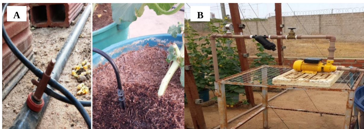
Figura 3. Botão gotejador e haste emissora (A); Filtro de disco e manômetro (B). Fonte: Pesquisa de campo, 2015.
