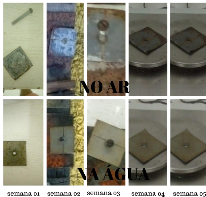
Figura15: Chapa De Zinco (Ar/Água)
