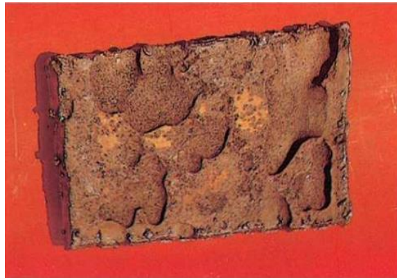
Figura 03: Corrosão em placa (Fonte: Gentil, 1996).
