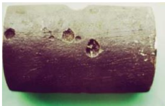
Figura 04: Corrosão alveolar (Fonte: Gentil, 1996).
