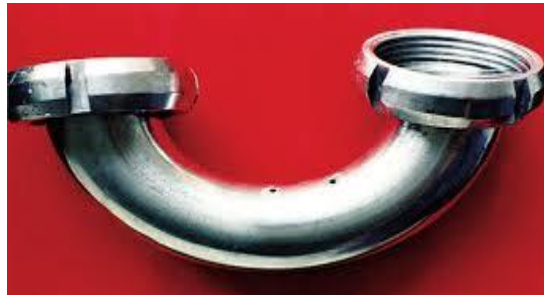
Figura 05: Corrosão puntiforme (Fonte: Gentil, 1996).
