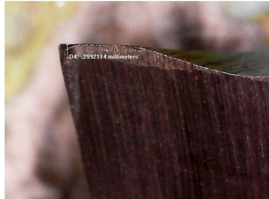
Figura 35 - (a) Ferramenta IA antes dos passes; (b) Ferramenta IA após os 36 passes.
